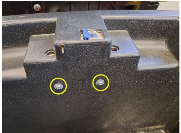
Irrota kaksi päävirtakytkimen kiinnitysruuvia (ristipäämeisseli).
