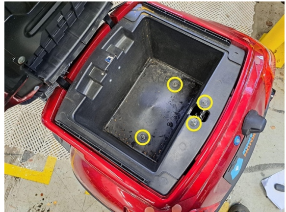
Irrota säilytyslokeron kiinnityspultit. (hylsy 8 mm). Käännä päävirtakytkin off-asentoon.
