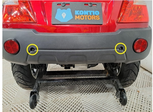
Irrota takakatteen kaksi kiinnityspulttia. (hylsy 8 mm).
